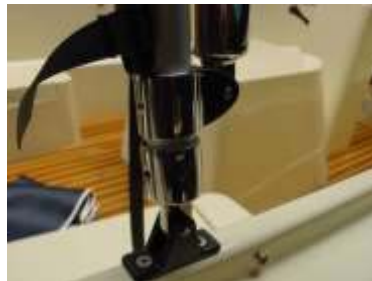
Stap 7 Haal borgpen uit de beugel en leg de kap op het voordek
