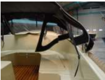
Stap 3 Sla de zijkanten naar binnen
